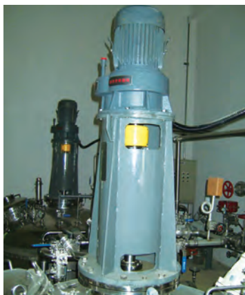
生化發酵槽(卡夾式機械軸封)
